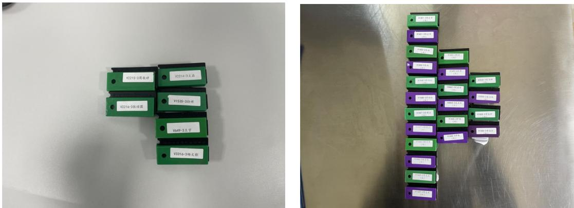
图 7-14 加速器机房和 DSA 机房辐射工作人员个人剂量片
