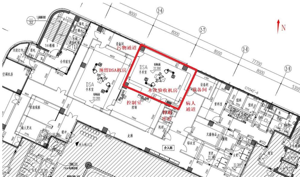
图 2-3 6层介入科 DSA 机房平面示意图
