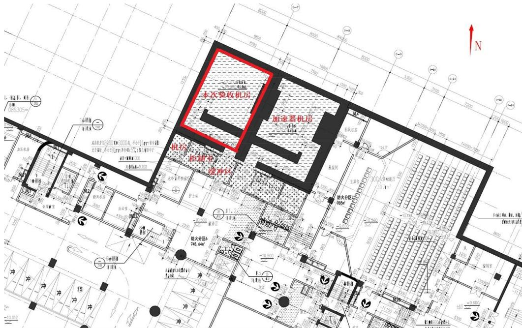
图 2-5 负 2 层医用电子直线加速器机房平面布局图
