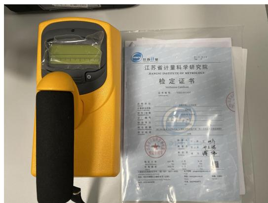
图 7-11 加速器项目 X- $\gamma$  剂量率测量仪
