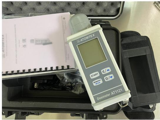
图 7-3 复合手术室机房 X- $\gamma$  剂量率测量仪（型号：AT1121）
